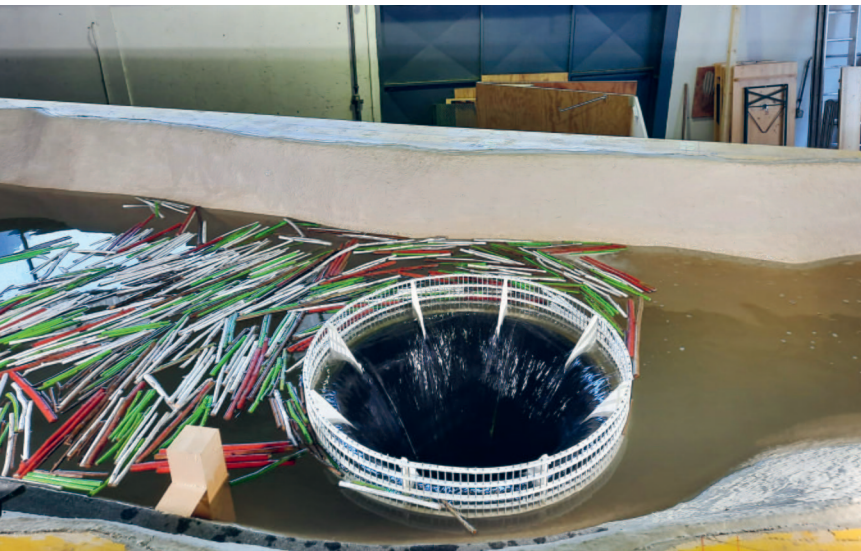
Bild 2 Modellversuch im Massstab 1:33 mit der Variante mit Makrorechen mit 8 Stützen.
