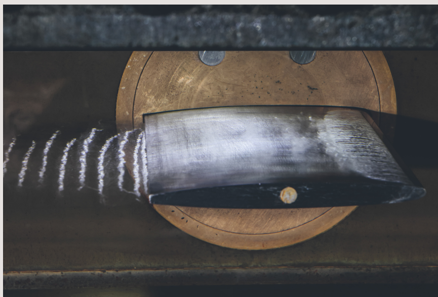
Figure 1 Visualisation des tourbillons de Kármán et de la cavitation dans le sillage d'un profil, avec cavitation attachée au bord d'attaque, lors de tests réalisés dans le tunnel de cavitation à haute vitesse de l'EPFL. Figure: EPFL/Alain Herzog
