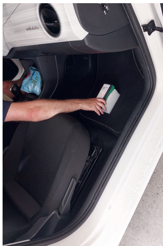
Messung im Fussraum vorne rechts. Die Messungen wurden in drei Abständen mit Distanzhaltern durchgeführt.
