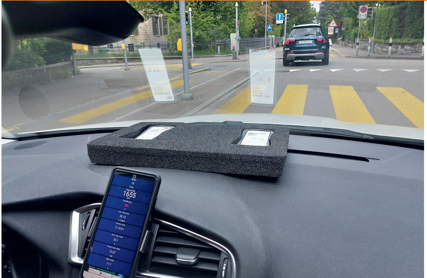
Messung unter der Frontscheibe links (Niederfrequenz) und rechts (Hochfrequenz).
