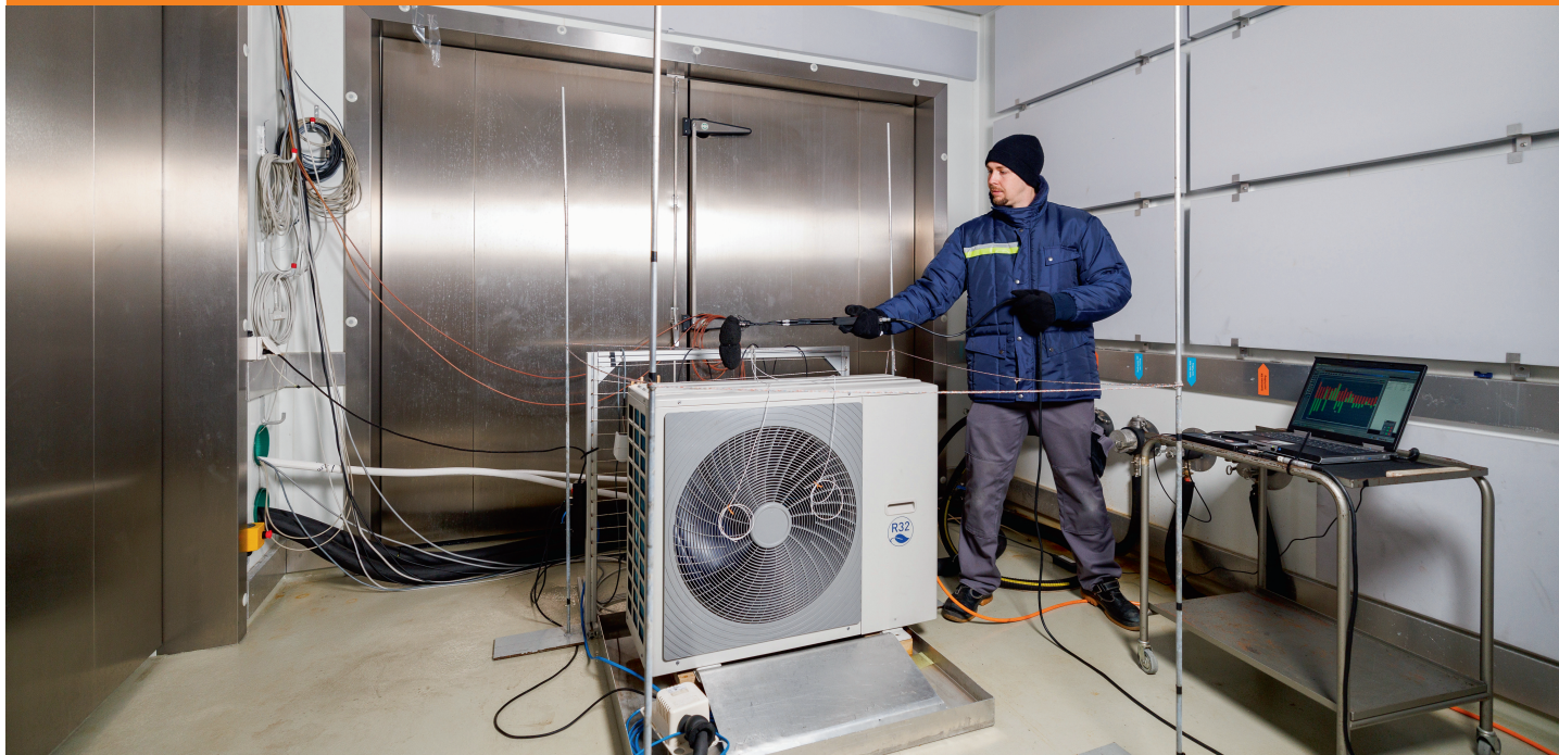
Luft-Wasser-Wärmepumpen-Test und Schallmessung am Wärmepumpen-Testzentrum (WPZ).
