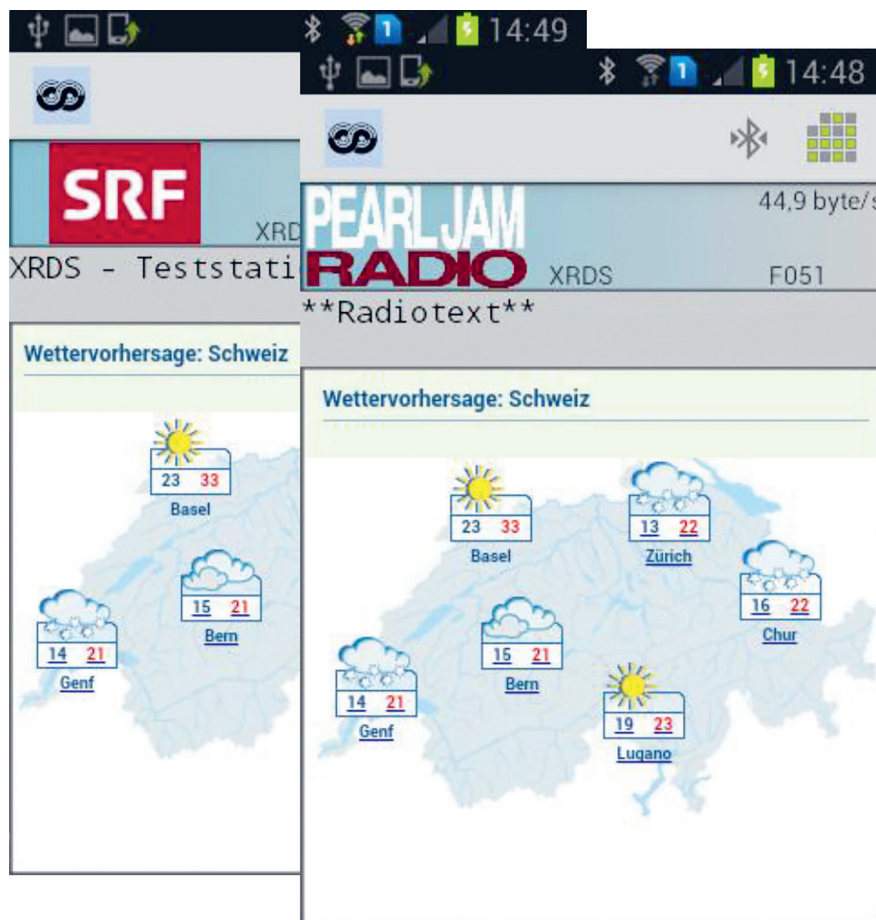
Mit RDS2 können Bilder übertragen werden. Eine Slideshow-Option wird zurzeit bei Radio France und im RDS Forum entwickelt.
