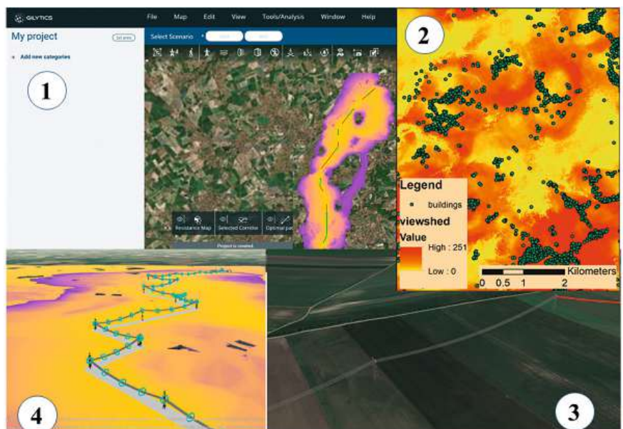
1) User-Interface mit Korridor und Pfad; 2) visueller Einfluss von Masten auf Gebäude; 3) 3D-Visualisierung von Masten und Freileitungen; 4) elektromagnetisches Feld der Freileitungen.
