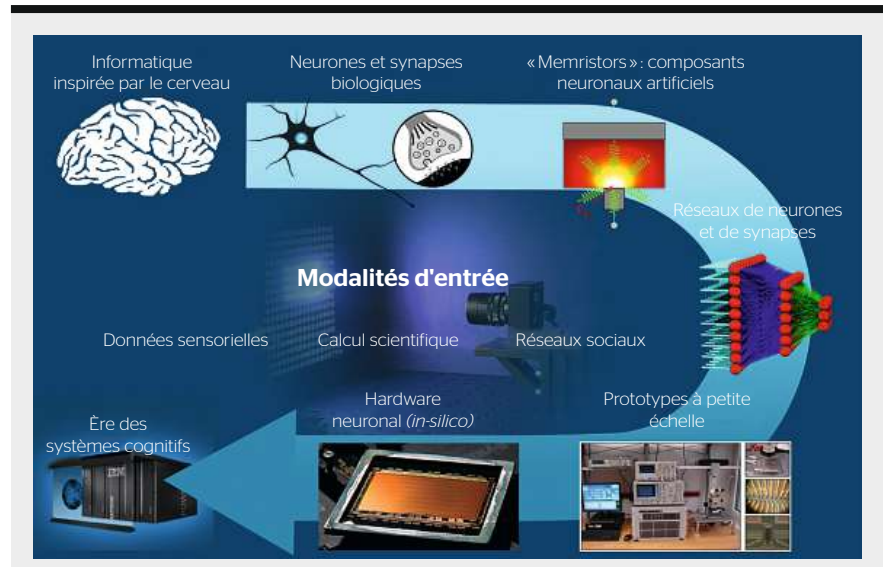
Figure 1 S'inspirant du fonctionnement interne du cerveau biologique, les ordinateurs neuromorphiques sont des systèmes construits à partir de neurones et de synapses artificiels connectés sous forme de réseau.
