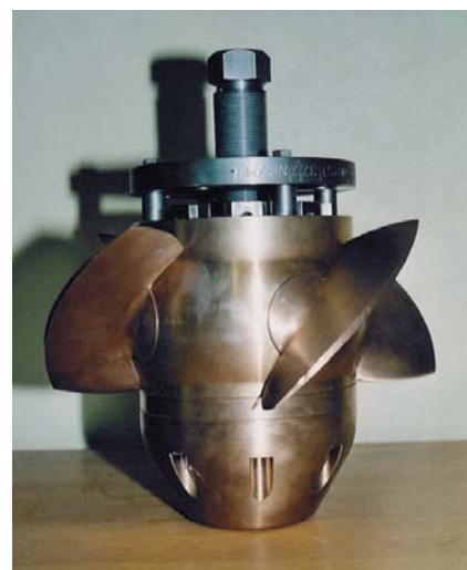
Figure 3 Roue à 4 pales du modèle réduit d'une Kaplan (diamètre externe de roue de 300 mm).
