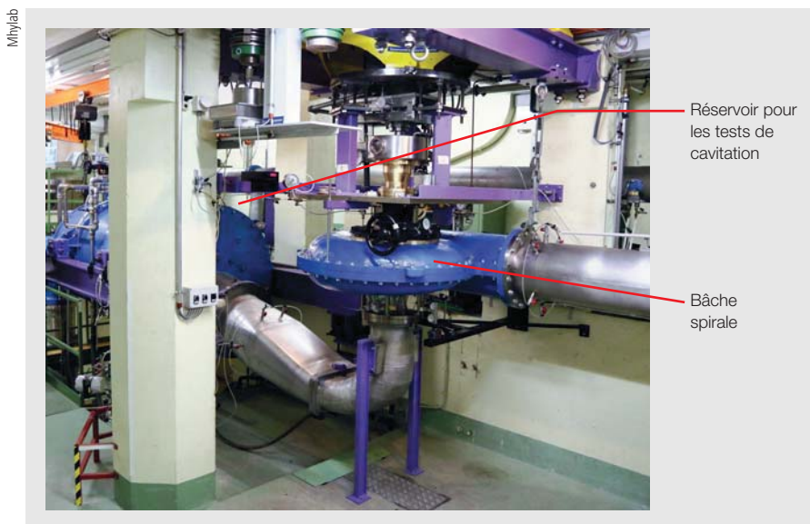
Figure 7 Turbine Diagonale à double réglage avec bâche spirale sur le stand d'essais.
