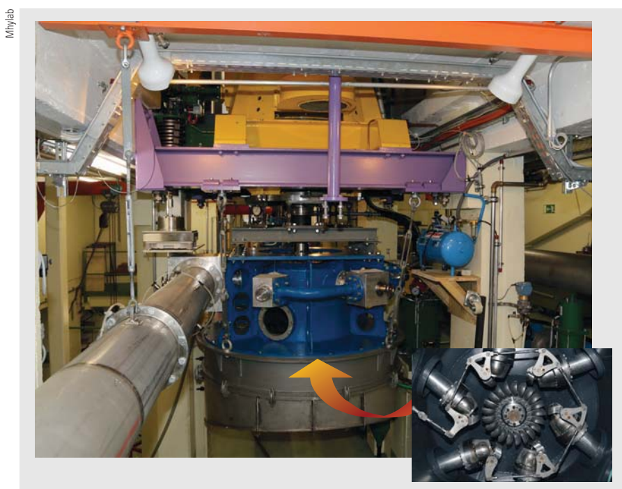
Figure 4 Turbine Pelton à 6 injecteurs [2] sur le stand d'essais.
