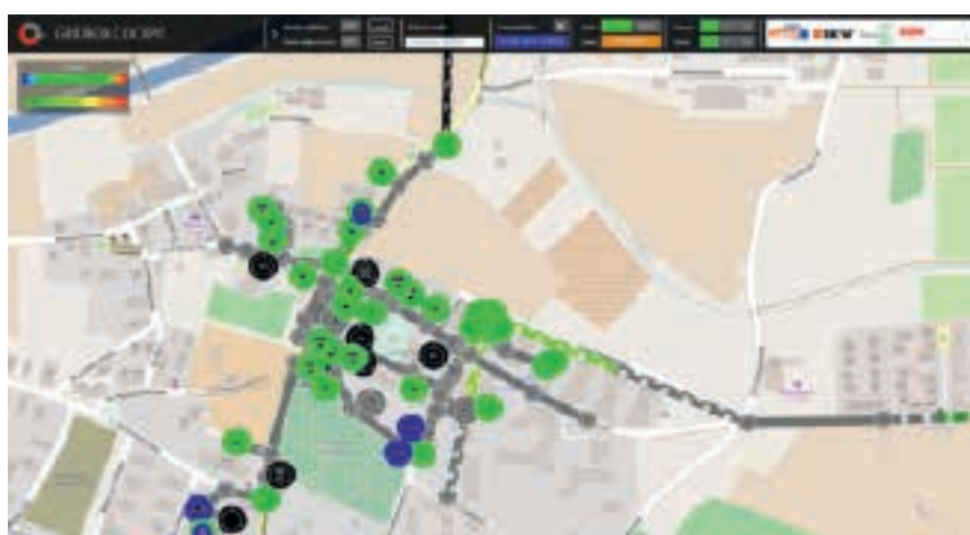
Bild 2 Visualisierung des Netzzustandes mit aktuellen Messwerten aller GridBoxes und animierten Leistungsflüssen in der geografischen Ansicht.
