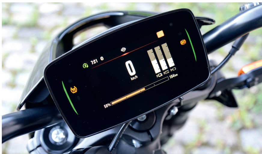
Clair et ordonné: l'écran indique les informations essentielles et peut afficher des données supplémentaires comme les températures de la batterie, de l'électronique de puissance et du moteur.
