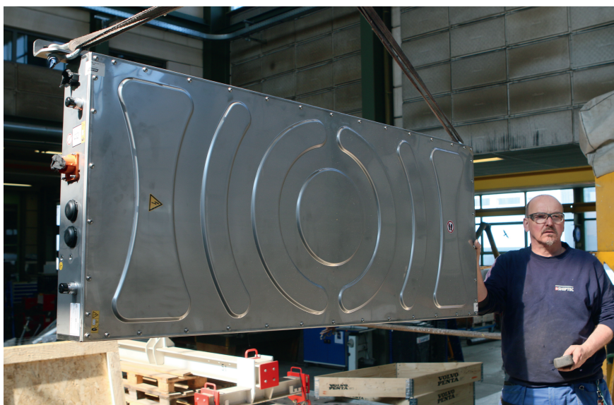
Une des trois batteries Akazem, d'une capacité de 33 kWh.
