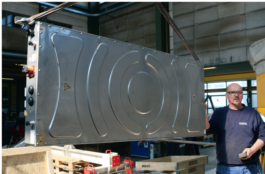
Eine der drei Akazem-Batterien mit 33 kWh Kapazität.
