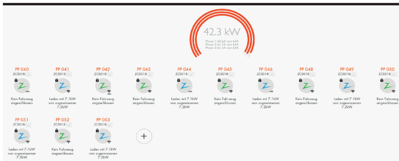
Bild 2 Dynamischer Phasenausgleich in Aktion: Vollständig symmetrische Belastung bei Ladung von sechs zweiphasig ladenden Fahrzeugen.
