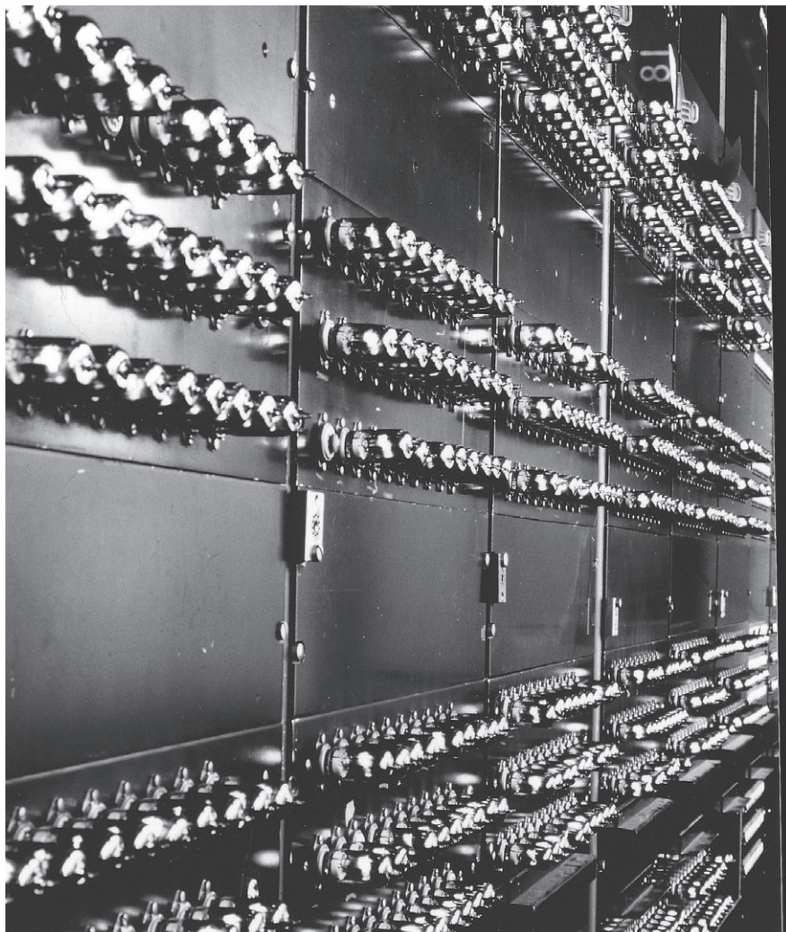
Bild 8 In den Einbrennbuchten erhalten die Röhren ihre Endqualität.
