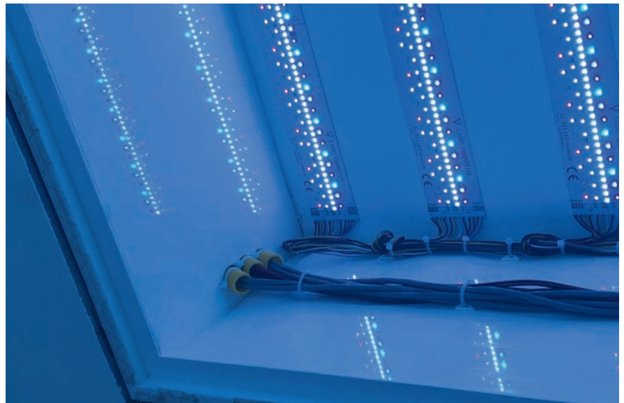
Figure 1 Détails de la partie électronique du système Light Cognitive Limitless.
