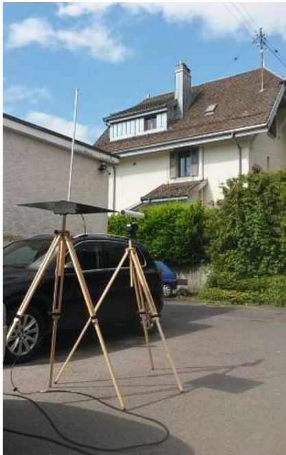
Figure 4 Antennes pour les mesures des perturbations électromagnétiques.
