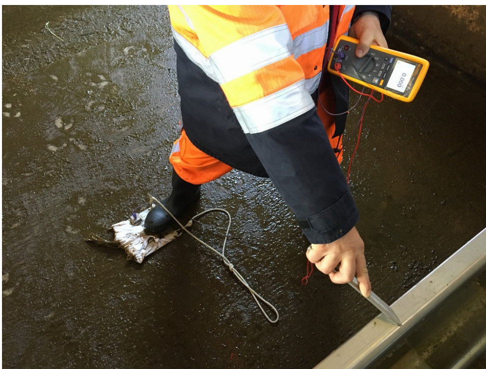
Figura 2 Misurazione della differenza di tensione alternata fra il pavimento dove si trova un bovino e un abbeveratoio di metallo. Una soluzione semplice per stabilire il contatto con il pavimento di calcestruzzo si ottiene utilizzando una piastra metallica avvolta in uno straccio bagnato. Per questa misurazione la distanza corrisponde approssimativamente a quella fino alle zampe anteriori.
