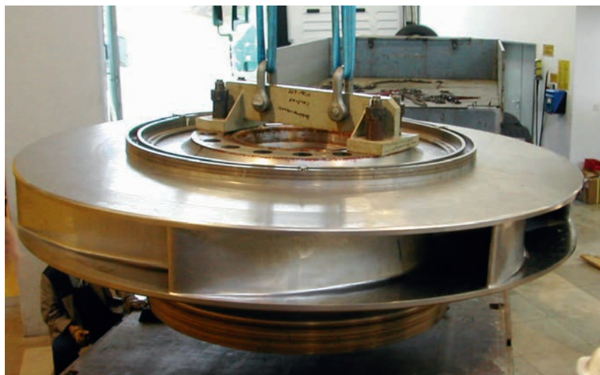
Bild 1 Laufrad einer Francis-Pumpturbine, Aussendurchmesser 3,0 m, Betriebsdrehzahl 8,35 s -1 , Durchfluss ≤32 m 3 /s.
