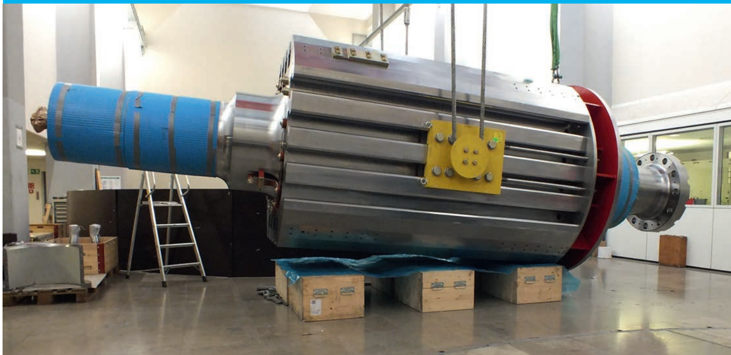
Rotorkörper der neuen vierpoligen Synchronmaschine, rechts Bremsring mit 2,5 m Aussendurchmesser und Flansch zur Turbinenkupplung, links Wellenende für Erregergenerator.
