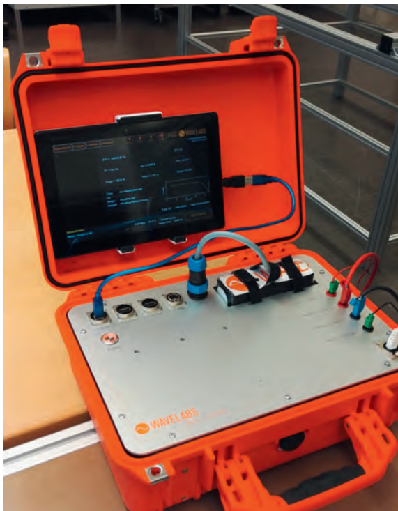
Bild 4 Die Auswerteelektronik wird von einer Batterie gespeist und die Auswertung der Messung erfolgt direkt auf dem Tablet mit Touch-Screen.
