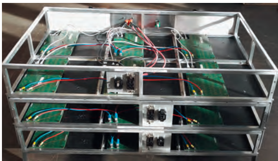
Bild 3 Die Beleuchtungseinheit des PLF lässt sich in drei Teile trennen und stapeln. Der Transport wird so deutlich vereinfacht.
