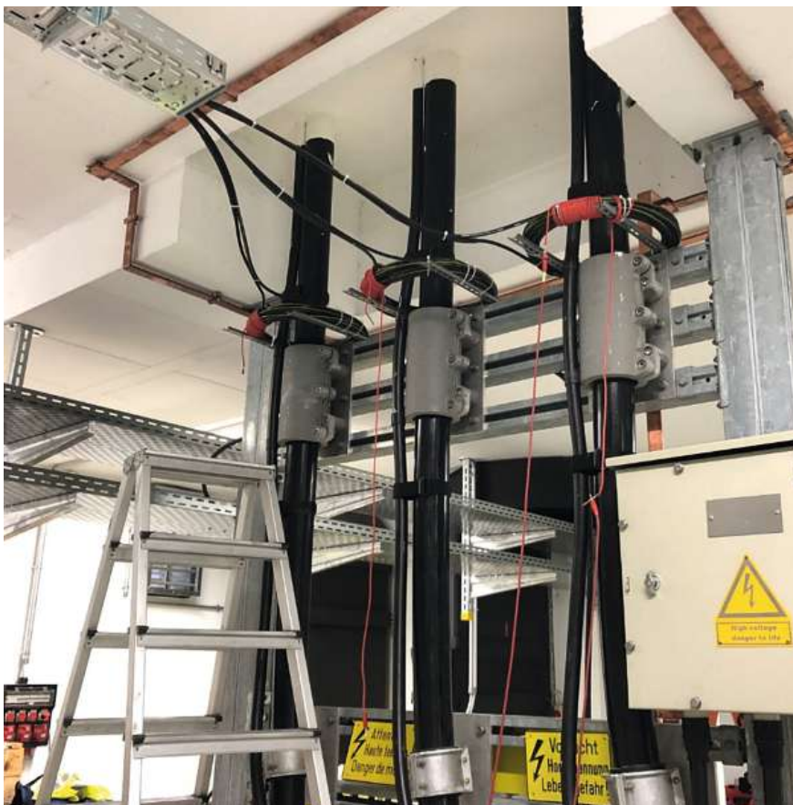
Bild 7 Site-Acceptance-Test-Setup mit mehreren Kupferwickeln für die Primärspannung des flexiblen optischen Stromwandlers.
