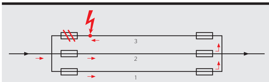
Bild 3 Je nach Lage der Fehlerstelle kann es erforderlich sein, an beiden Enden der Leitung Überstrom-Schutzeinrichtungen anzuordnen.
