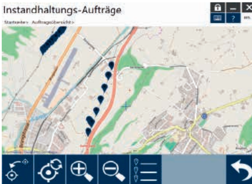
Bild 5 Auf einer Karte zeigt das System an, welche Verteilanlagen (Tragwerke) sich in der Nähe des aktuellen Standorts befinden.
