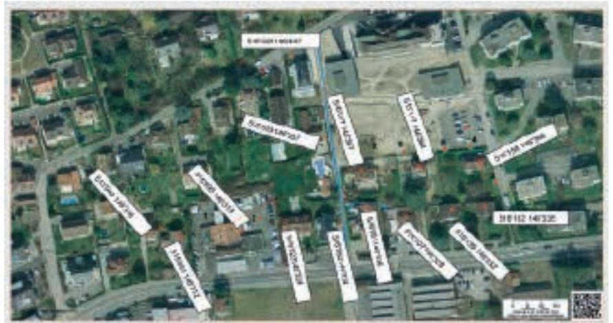
**Bild 3** Messpunkte (blau umrahmte rote Punkte) zur Erhebung von elektromagnetischen Störungen im Bereich des Spitals Rolle. Die roten Linien bezeichnen Freileitungen (Leitungen oder Kabel), während die blauen Linien unterirdische Verbindungen markieren.
