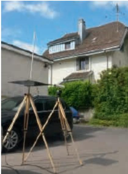
**Bild 4** Antennen zur Messung von elektromagnetischen Störungen.
